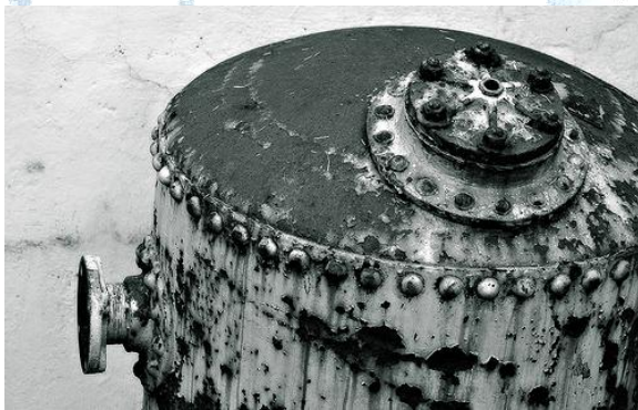
Recipiente a Presión remachado (izquierda) y Primer Recipiente soldado, 1930 (derecha).
